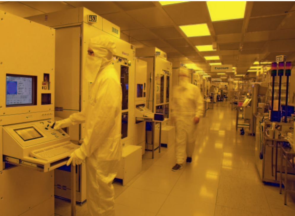
Fertigung von SAW-BAW-Filtern beim Elektronikspezialisten Epcos.
